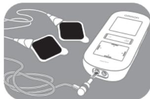
**Примечание.** Не включайте прибор до тех пор, пока электродные пластины с гелевыми накладками не будут закреплены на коже.
