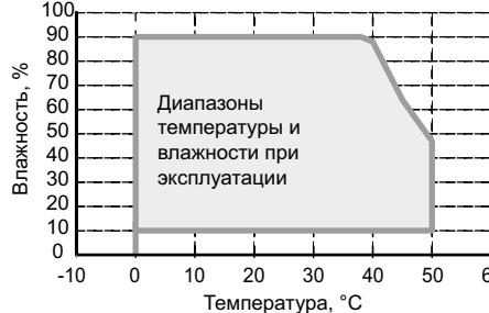
\*3. Панель оператора следует хранить в пределах диапазонов температуры и влажности, показанных на графике.
