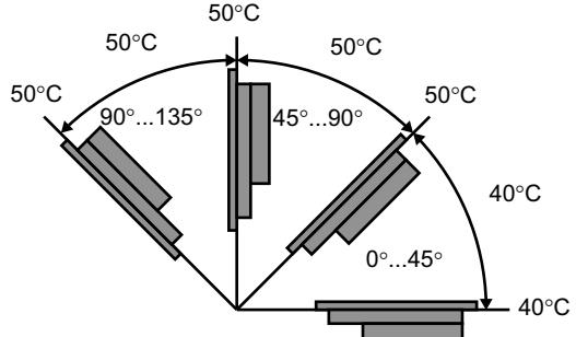
\*2. Панель оператора следует эксплуатировать в пределах диапазонов температуры и влажности, показанных на графике.
